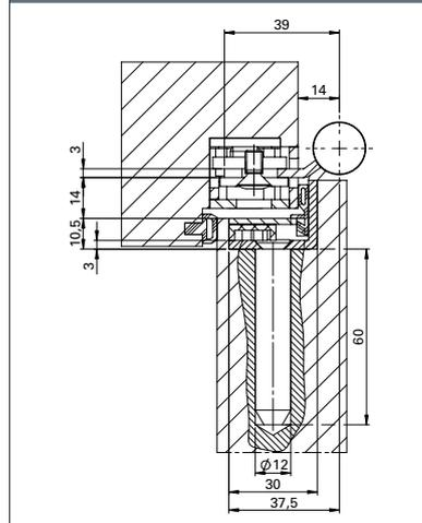
**Querschnitt mit Sicherheitszapfen (SI)**
