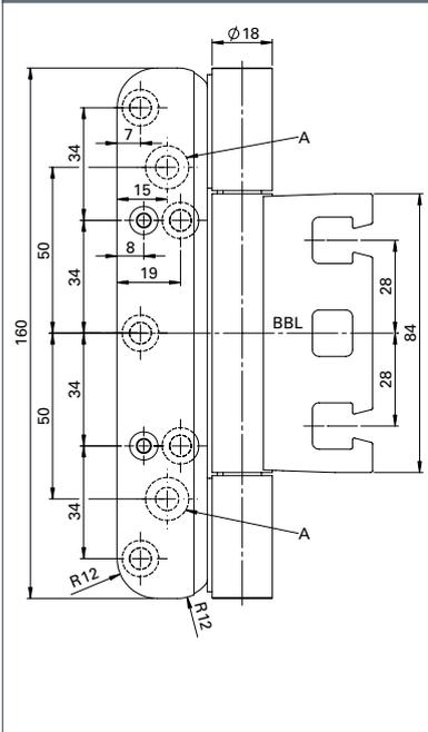
**Querschnitt mit Tragzapfen (TZ)**
