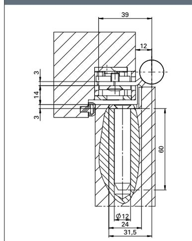
**Querschnitt mit Sicherheitszapfen (SI)**
