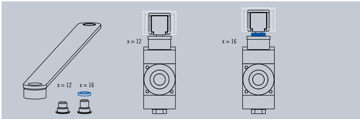
Die integrierten Türschließersysteme ECO ITS 420 und ECO ITS Multi-Genius sind in verschiedenen Türprofilen mit unterschiedlichen Falzraummaßen einsetzbar. Dies wird durch die Gelenkschraube mit unterschiedlichen Nusslängen (x) am Hebelarm ermöglicht.
