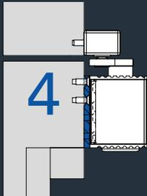
Die Direktmontage ist die Standard Montageart bei ECO. Die Gleitschiene wird direkt auf die Zarge montiert. Dazu müssen die ECO Befestigungsbohrungen vorgerichtet werden. Die entsprechenden Bohrungen sind auf den folgenden Seiten dargestellt.
