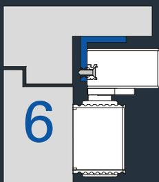
Der Sturzfutterwinkel (SFW) wird bei Montage auf Bandgegenseite eingesetzt, wenn die Gleitschiene aus Platzgründen (breiter Türsturz) unter die Zarge montiert werden muss. Der SFW wird von unten an die Zarge geschraubt und die Gleitschiene dann am SFW befestigt.
