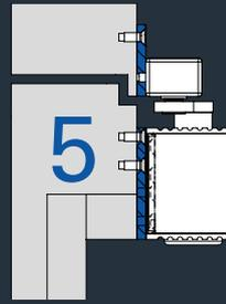
Das Adaptionprofil (ADP 40) wird verwendet, wenn die Zargenkonstruktion eine stabile Befestigung der Gleitschiene nicht zulässt, z.B. bei Zargen von Profiltüren. Das Adaptionprofil wird oberhalb der Gleitschiene in der Profilkammer der Zarge befestigt. Die Gleitschiene kann jetzt stabil auf dieses ADP montiert werden. Es ist als Zubehör separat zu bestellen.
