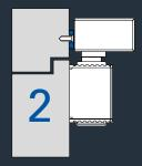
Die Montage mit Standardprofil (ADP 20) wird verwendet, wenn die Zarge bereits mit dem Montagebohrmaß 120/428,5 mm vorgerichtet wurde, z.B. bei Stahlzargen oder bei Austausch/Nachrüstung.
