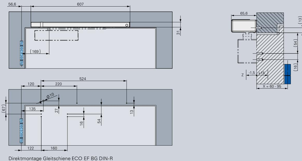
Direktmontage Gleitschiene ECO EF BG DIN-R
