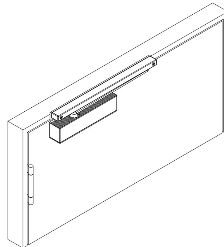
**Anbauvariante Adaptionprofil (ADP 30) und Montageplatte**
