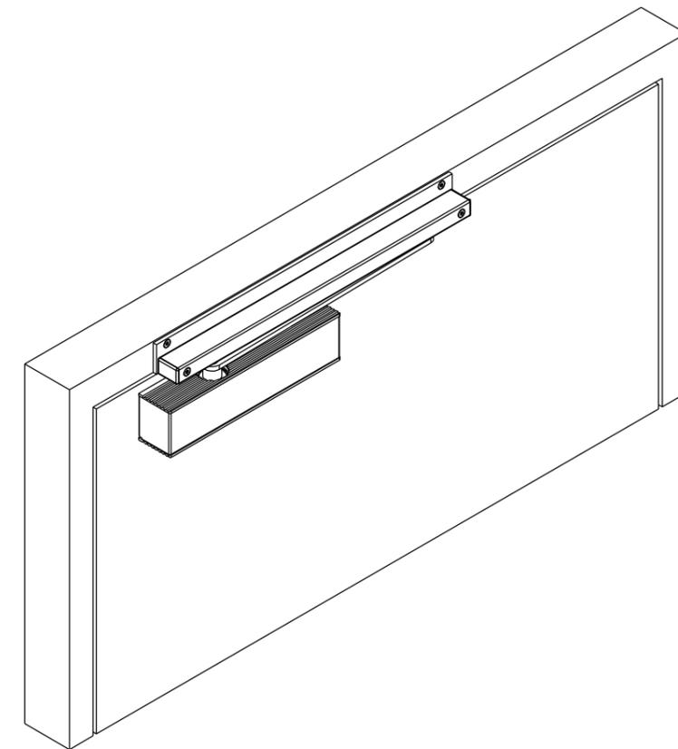
**Anbauvariante Adaptionprofil und Montageplatte**
