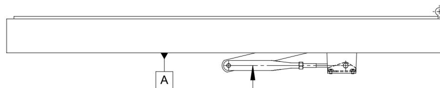
Anbauvariante Direktmontage + Scherengestänge (SGS)
