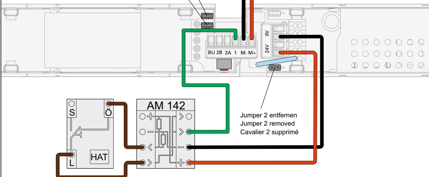
Beträgt die Haltekraft der Magnete mehr als 120 Nm / mehr als 80N (gemessen am Türdrücker), muss ein Handauslösetaster HAT 02 eingesetzt werden.
