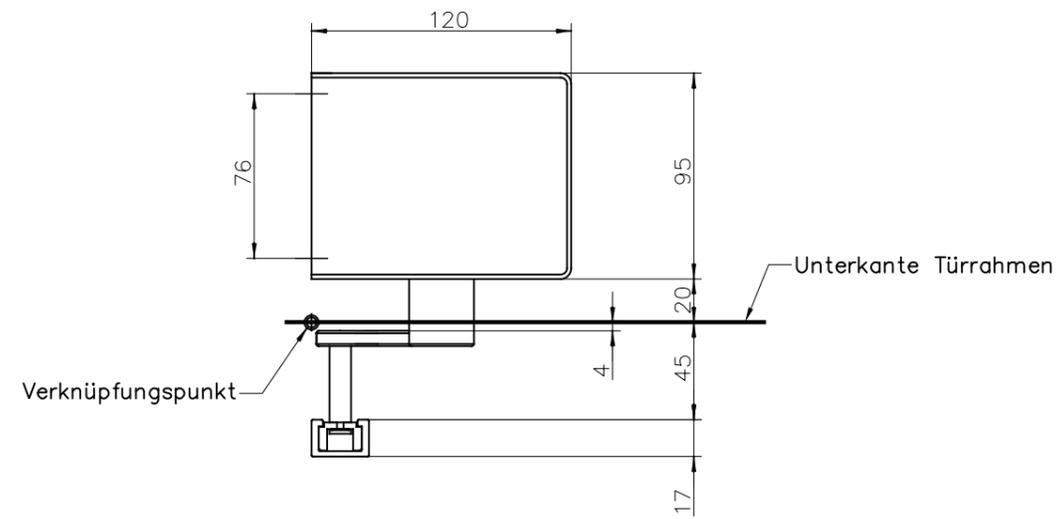
Bohrbild für Befestigungsbohrungen ETS 73 und Gleitschiene
