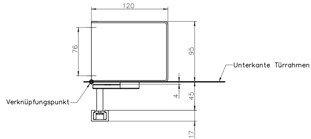
Bohrbild für Befestigungsbohrungen ETS 73 und Gleitschiene
