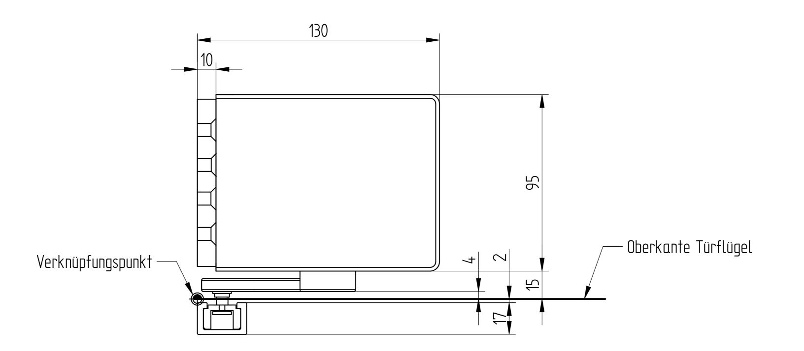
Bohrbild für Montageplatte und Gleitschiene
