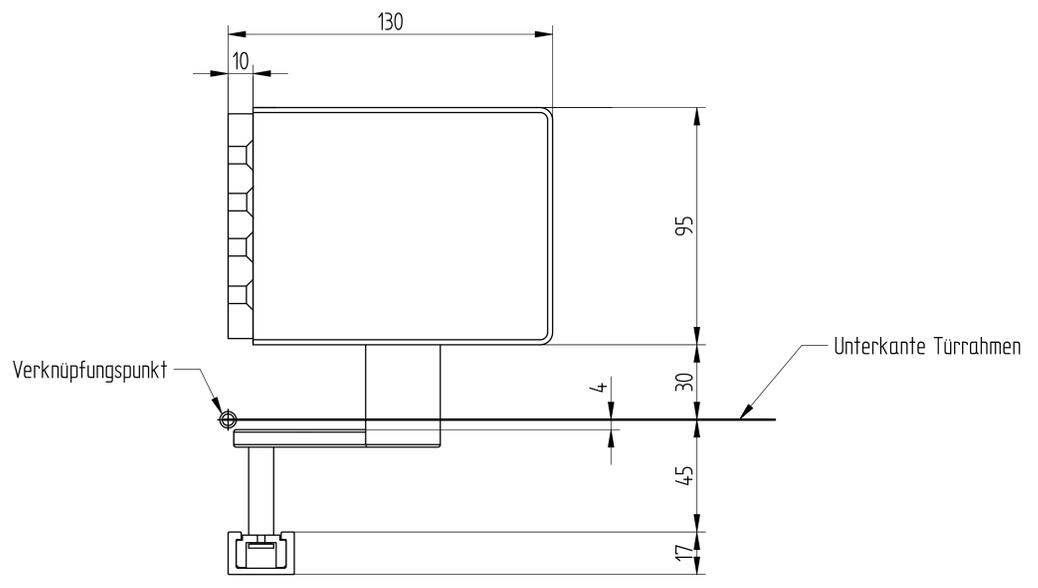
Bohrbild für Montageplatte und Gleitschiene
