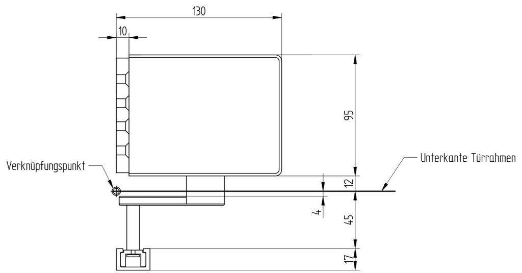
Bohrbild für Montageplatte und Gleitschiene
