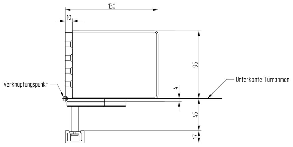
Bohrbild für Montageplatte und Gleitschiene
