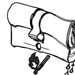
Schließzylinder müssen aus oberhalb von 800°C schmelzenden Werkstoffen bestehen!
